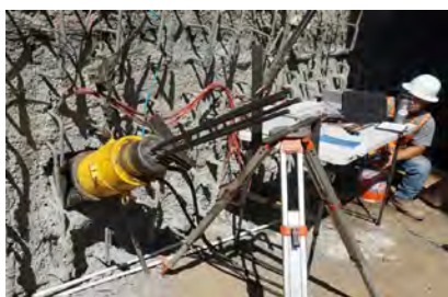
Фиг. 1 Приложение на FOS за мониторинг на анкери и пилоти. (Geo Monitoring, Berkeley, 2023).
