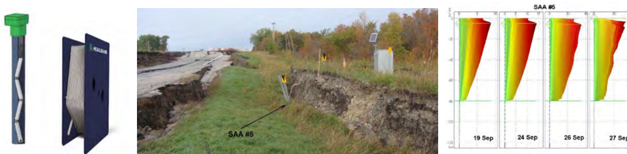
Фиг. 2 Пример с използване на SAA при мониторинг на свлачище (Dasenbrock 2010)
